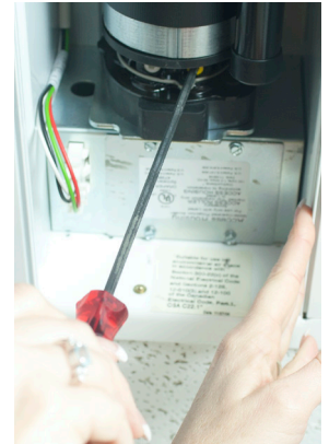
"UP" Limit (yellow) "AUF" Grenze (gelb) Vis de réglage de limite supérieure (jaune)
