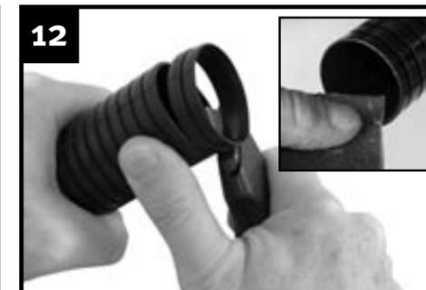
Corte el tubo en la ranura usando una navaja con filo para asegurar un corte rectangular plano. Elimine las rebabas del extremo cortado con papel lija.
