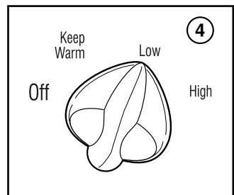
Le bouton de commande sur la mijoteuse offre un réglage à faible et haute températures pour la cuisson. Le réglage de maintien de la température (**Keep Warm**) sert à maintenir le mets préparé à une température de service idéale.
