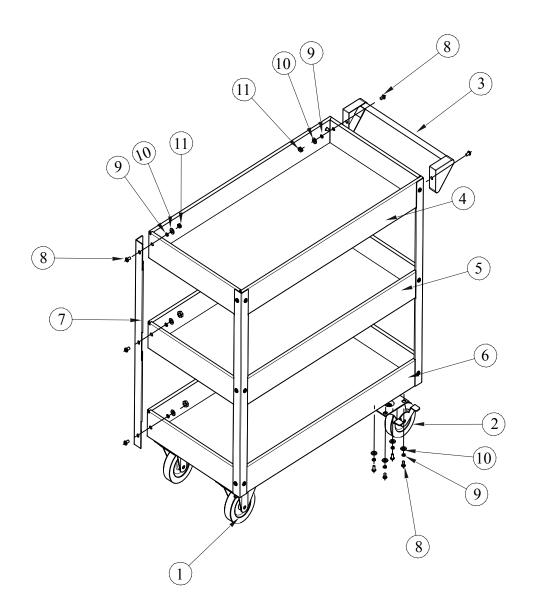
THE MAXIMUM LOAD CAPACITY FOR EACH TRAY SHOULD BE NO MORE THAN 100LBS THE MAXIMUM LOAD CAPACITY FOR THE PRODUCT SHOULD BE NO MORE THAN 275LBS
