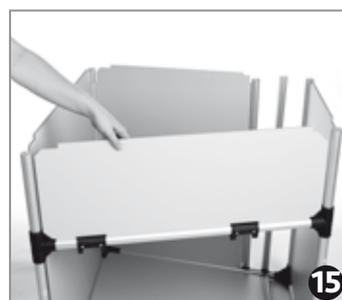
Zuletzt setzen Sie das linke Seitenelement auf. Drücken Sie bei diesem Arbeitsschritt alle vier Ecken kräftig und ganz gleichmäßig hinunter. Es ist normal, dass die Transportbox bei der Montage dieses Teils stark unter Spannung steht. Dies ist notwendig, um ein späteres Klappern während der Fahrt zu verhindern. Sollte sich die letzte Wand nicht korrekt aufsetzen lassen, ist es hilfreich die vormontierten Schrauben dieses Elements an den Ecken zu lockern.
