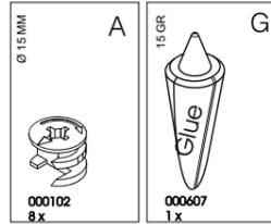
Het gebruik van een beetje houtlijm (maximaal 2 druppels per boor gat ) is noodzakelijk voor een goede verbinding.
