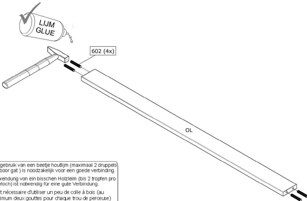
Het gebruik van een beetje houtlijm (maximaal 2 druppels per boor gat ) is noodzakelijk voor een goede verbinding.
