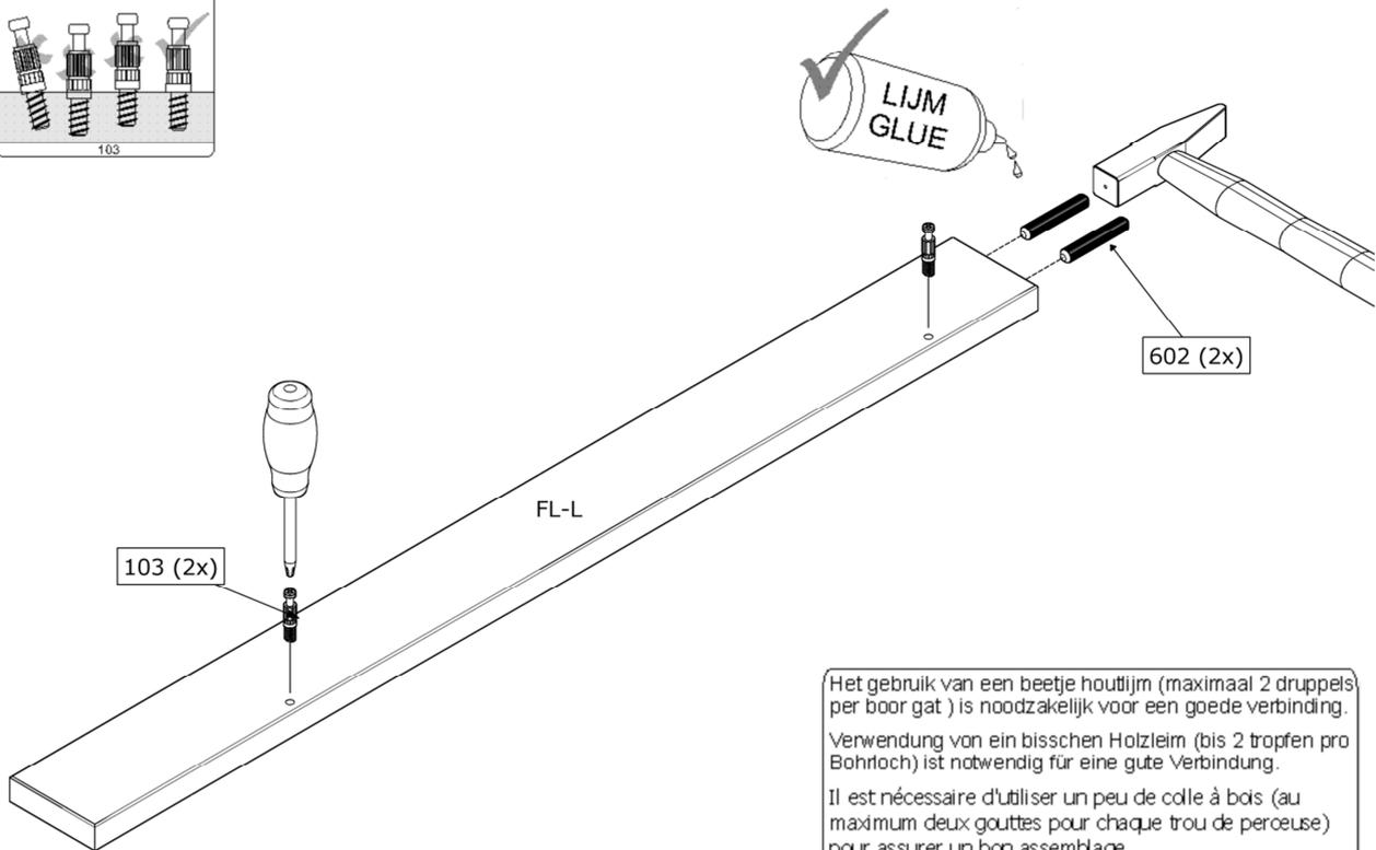
Het gebruik van een beetje houtlijm (maximaal 2 druppels per boor gat ) is noodzakelijk voor een goede verbinding.
