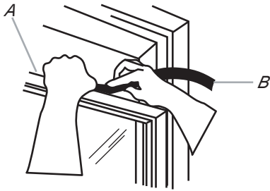
A. Parte superior del marco de la hoja inferior. B. Sello de espuma
