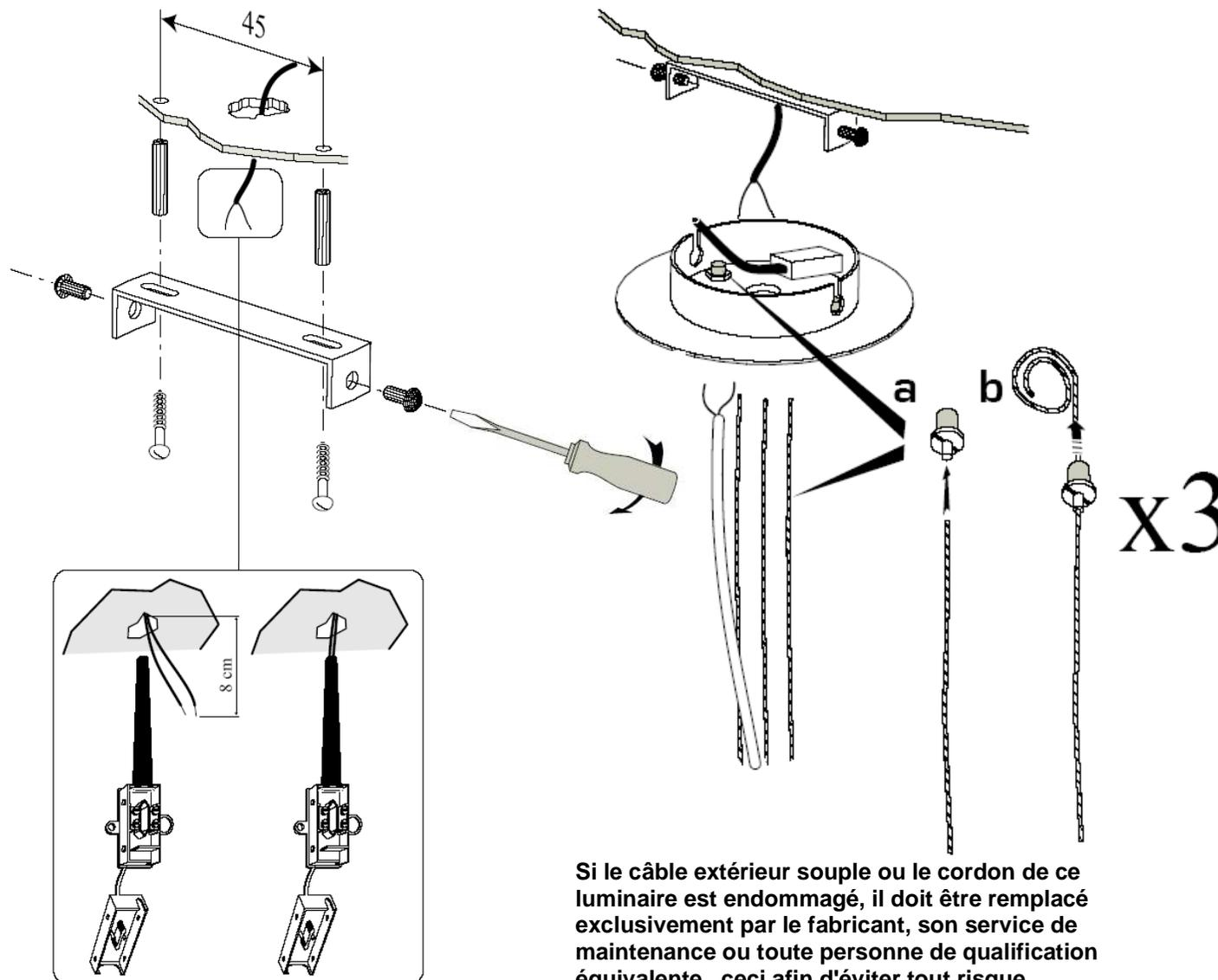
Si le câble extérieur souple ou le cordon de ce luminaire est endommagé, il doit être remplacé exclusivement par le fabricant, son service de maintenance ou toute personne de qualification équivalente, ceci afin d'éviter tout risque.
