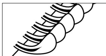
Le brûleur doit être nettoyé: Brûleur brouillé avec flammes bleues.
