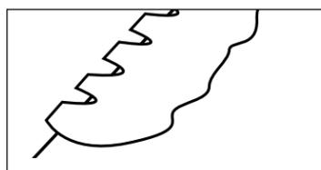
Le brûleur doit être remplacé: Flamme jaune ondulante.
