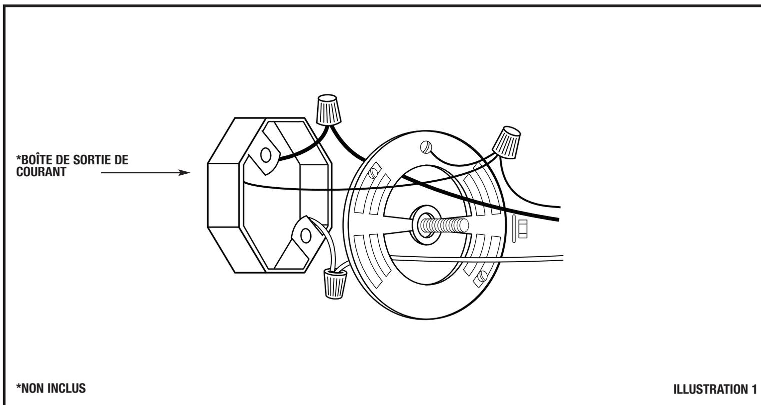
**IMPORTANT : NE FIXEZ PAS L'APPAREIL D'ÉCLAIRAGE DIRECTEMENT À LA BOÎTE DE SORTIE DE COURANT.**
