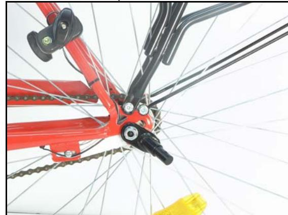
Pour positionnement contact du chevalet d'arrimage à la caravane pour une bicyclette à 28 ou 26 pouces, assurez que l'angle droit vers le bas de telle sorte que la caravane soit au niveau horizontalement derrière la bicyclette.
