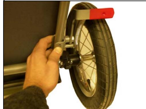
Insérez les deux boulons dans les trous et assurez les boulons. Utilisez le tourne à gauche numéro 10 pour assurer les boulons du frein de parking.
