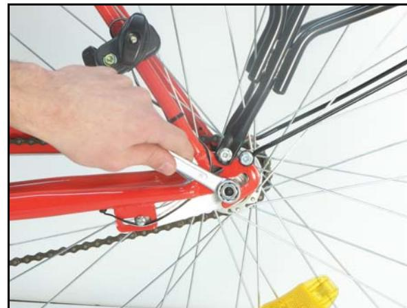
Stecken Sie das Kupplungsstück auf die Achse sodass der Zapfen nach rückwärts zeigt. Schrauben Sie den Achsbolzen wieder auf die Achse und ziehen Sie ihn leicht an.
