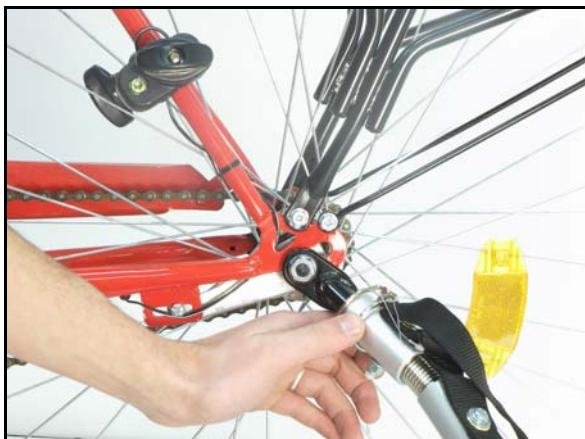
Wichtig: Als eine zusätzliche Sicherheitsmaßnahme für den Anhänger ist ein Gurt an der Zugstange befestigt. Dieser Gurt sollte lose um einen Teil des Fahrradrahmens gewickelt und mit der Öffnung am Ende der Zugstange verbunden werden.
