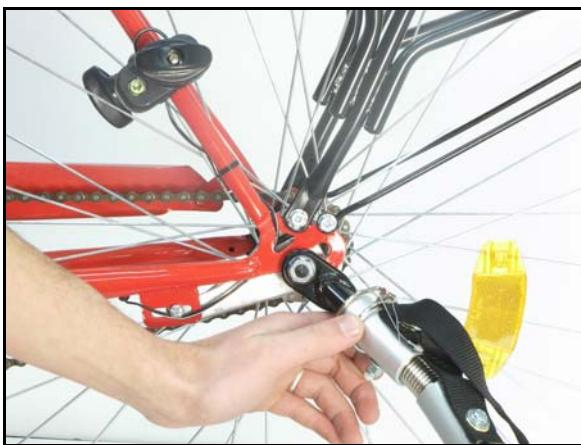
Important: Comme une mesure de sécurité supplémentaire une courroie est attachée à la barre de remorquage. Cette courroie doit être enveloppée autour du cadre de la bicyclette et branchée à l'ouverture au bout de la barre de remorquage.
