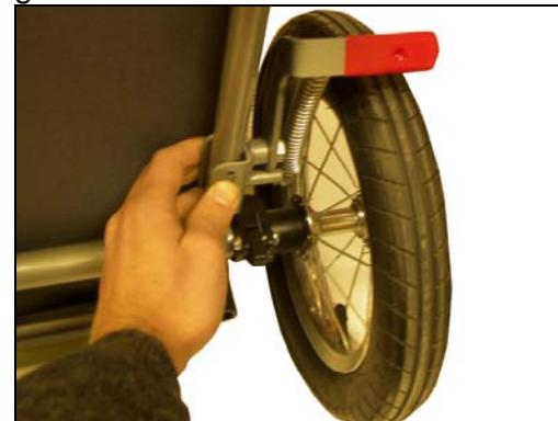
Positioneer de 2 meegeleverde bouten in de gaten en draai aan de bovenzijde de 2 moeren op de bouten. Draai het geheel goed vast met een moersleutel No. 10.
