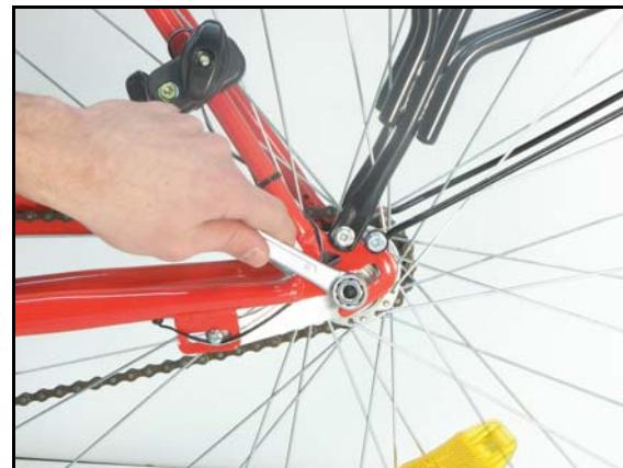
Placez le chevalet d'arrimage sur l'essieu et positionnez le goujon face vers l'arrière. Vissez le boulon de nouveau pour l'essieu et verrouillez-le un peu.
