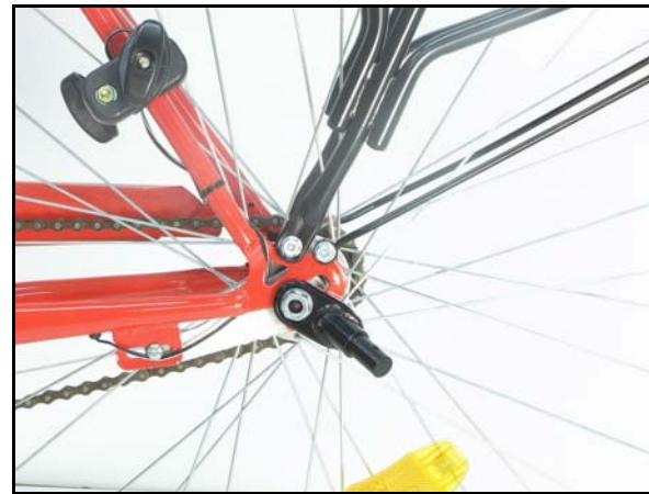
Um die richtige Position des Kupplungstecks zum Anhänger für ein 28 oder 26 Zoll Fahrrad zu finden muss sich der Anhänger in horizontaler Lage hinter dem Fahrrad befinden. Danach den Bolzen fest anziehen und die Montage der Anhängerkupplung ist beendet.
