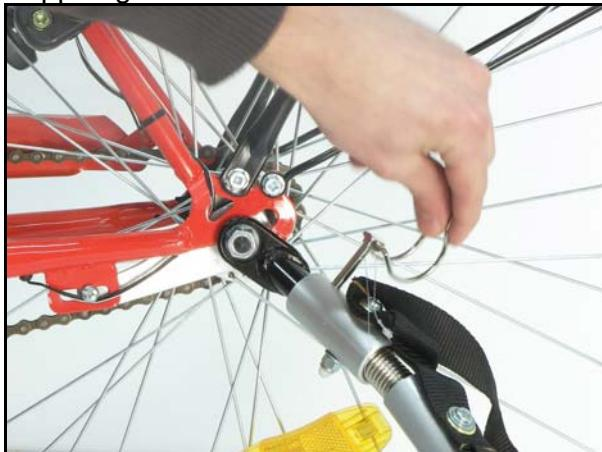
Schieben Sie den Sicherheitsbolzen durch das Loch und sichern Sie den Bolzen.
