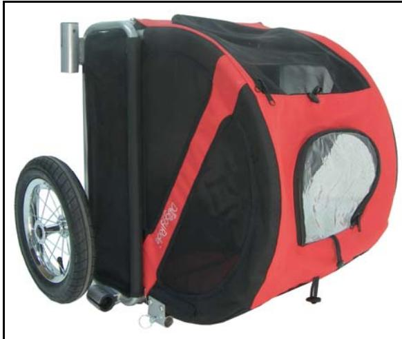
Installez la barre de remorquage dans le support sur le centre au devant de la caravane. Utilisez le goujon à relâchement rapide pour attacher la barre de remorquage. Le goujon à relâchement rapide est attaché par un levier.
