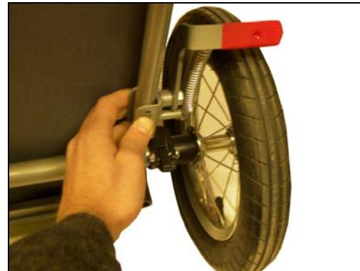
Stecken Sie die zwei Bolzen in die zwei Löcher und sichern Sie die Bolzen. Zum Sichern der Parkbremsenbolzen 10mm-Schlüssel verwenden
