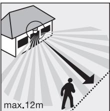
yhteydessä. Tunnistin kannattaa asentaa pienessä kulmassa kulkusuuntaan eikä esim. puu tai seiniä saa olla esteenä. Myös sisä-äärirakenne voidaan hámäräkytkin (LDR) säädetään portaattomasti
